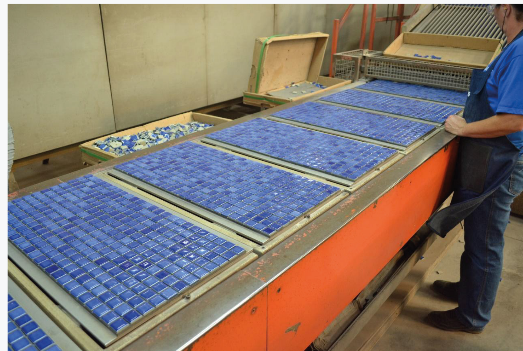
Montagem final dos painéis para a fase de colagem
