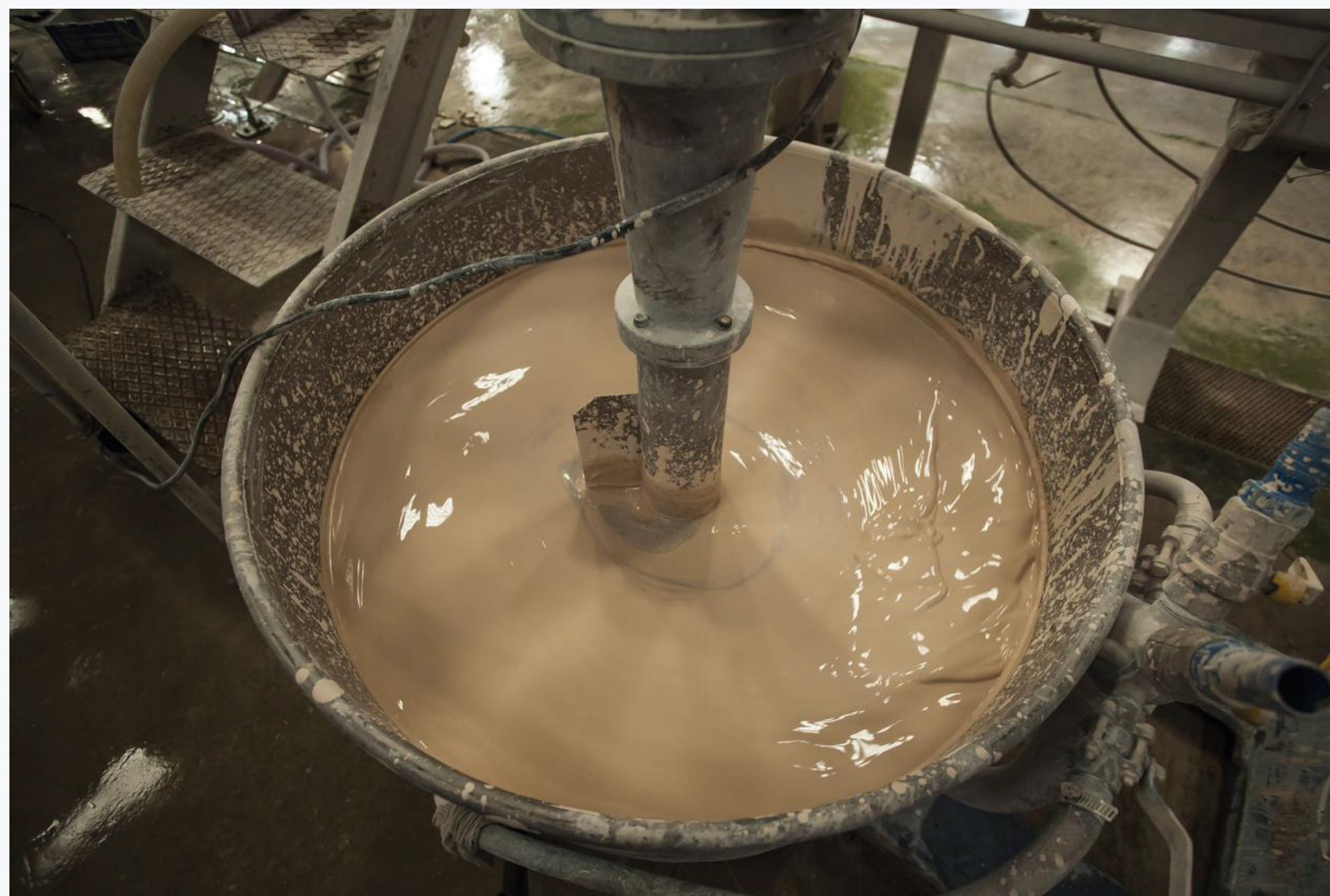
Processo de homogeneização do material que forma o revestimento cerâmico
